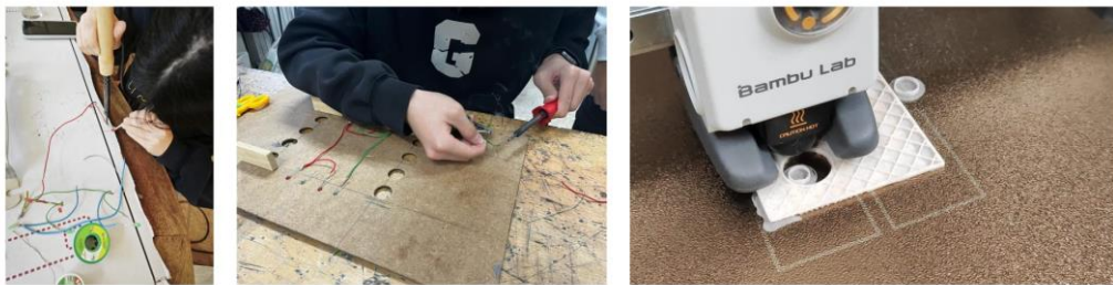
Figura 6: Fases de soldadura de cableado y componentes electrónicos, así como la fabricación de piezas 3D con impresora Bambu Labs.
