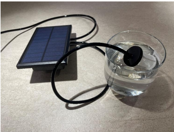
Fig.17 Sistema de riego por goteo impulsado por una placa solar
