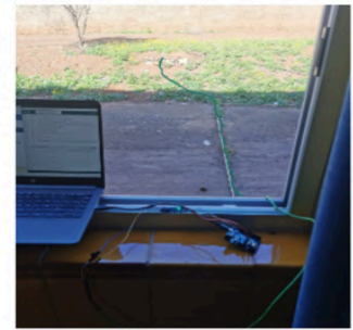
Robot 3. Con un cable RJ45 cat 6/7 controlamos todo el sistema en exterior desde el interior.
