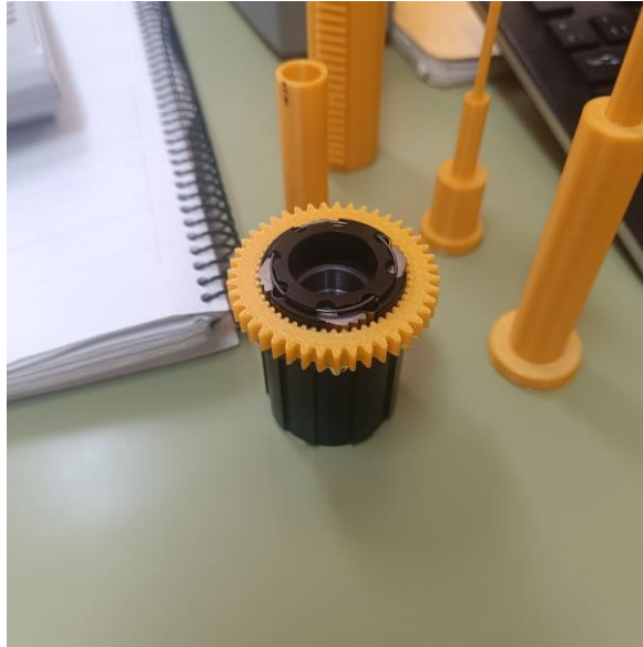
Figura 8. Piezas del prototipo fabricadas mediante impresión 3D utilizando filamento plástico. Tomada por Sonia García.
