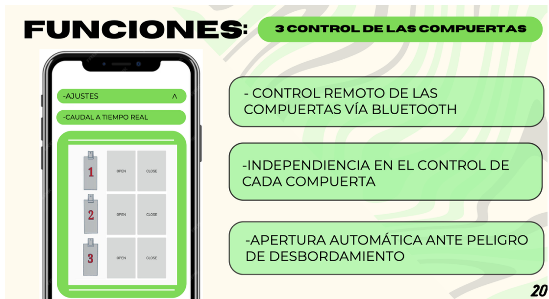
Figura 11. APP del móvil para controlar la apertura/cierre de las compuertas.
