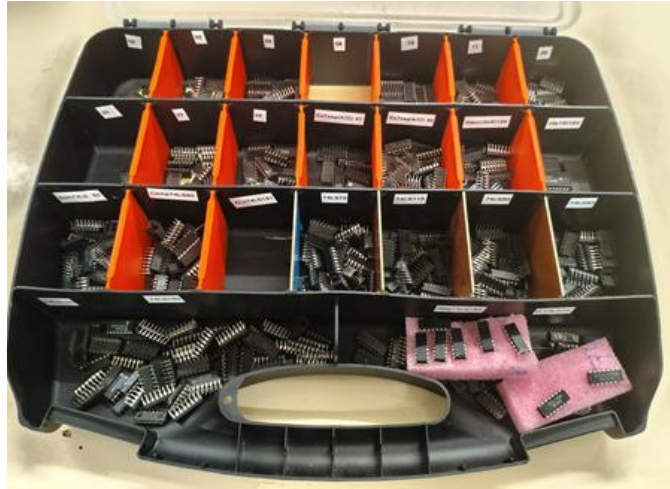
Figura 7. Circuitos integrados usados en la fabricación de las partes del procesador.
