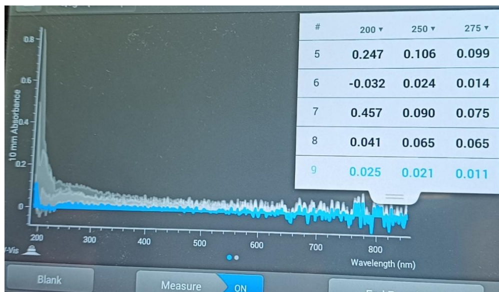
Figura 9. Gráfica con varias mediciones de absorbancia del NanoDrop™ One (Elaboración propia)
