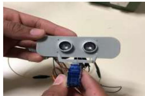
Figura 4 y 5: Diseño 3D de la carcasa e impresión con impresora de resina.
