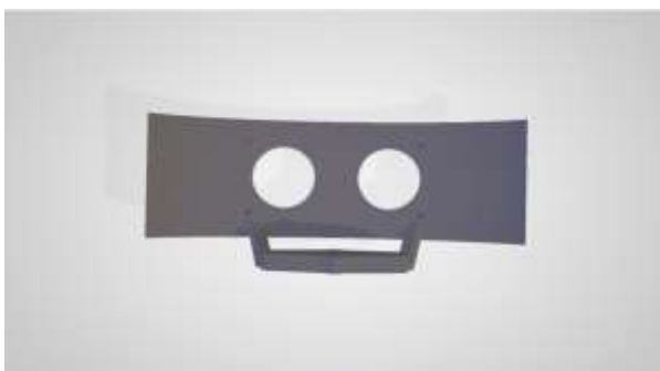
Figura 4 y 5: Diseño 3D de la carcasa e impresión con impresora de resina.
