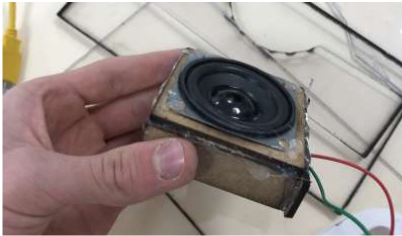
Figura 6: Cajado por corte láser para el altavoz.
