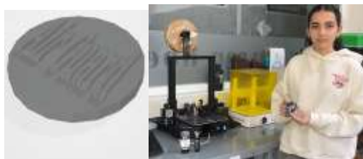
Figura 17: Diseño 3D de tapacubos para impresión en PLA y tapacubos impreso y pintado con pintura acrílica
