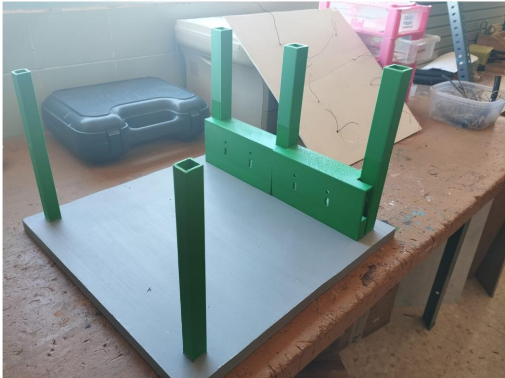
Figura 11: Montaje de la estructura
