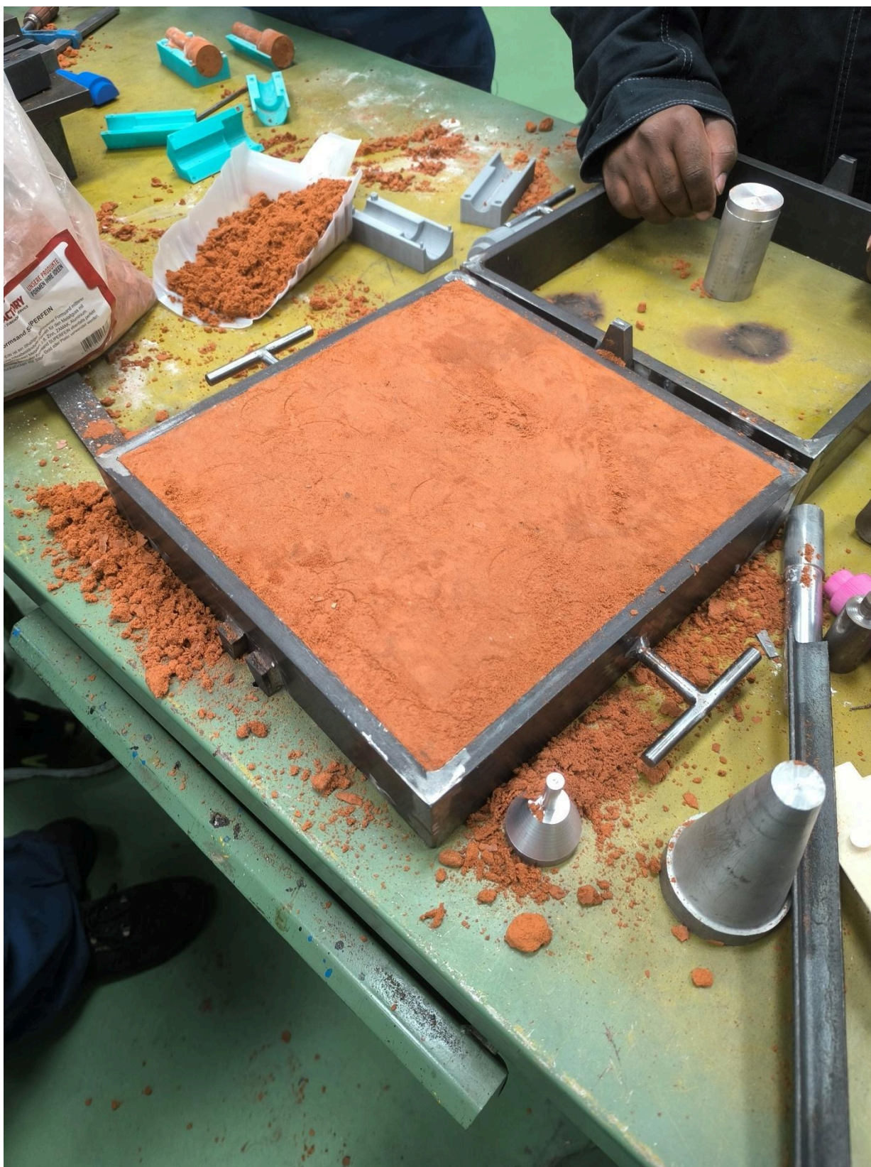
Figura 8. Compactación de la arena de moldeo. Fuente: Elaboración propia.
