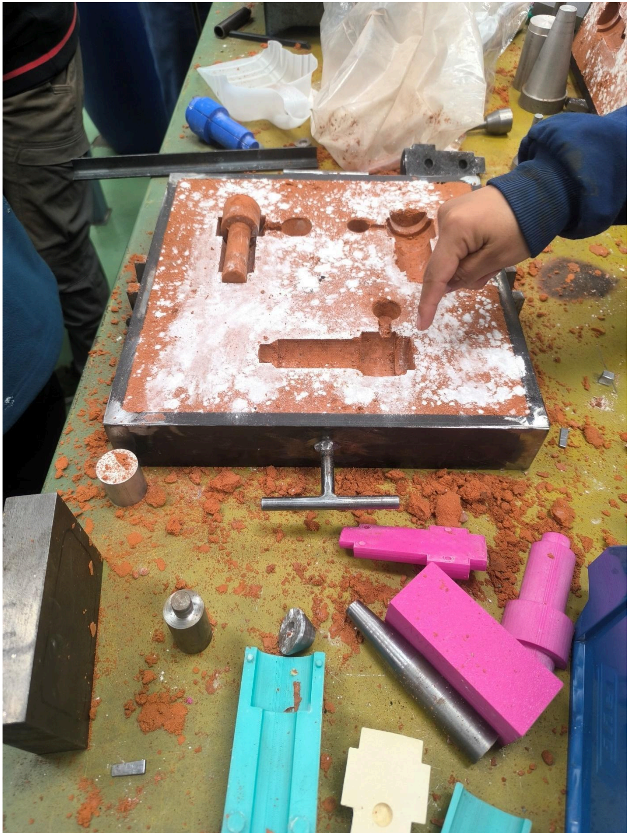
Figura 10. Retirada de los bebederos y mazarotas y colocación de los machos.
