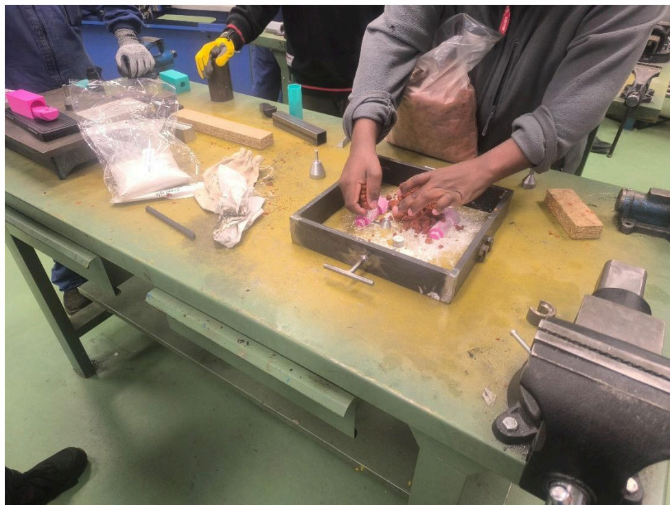
Figura 6. Colocación del modelo en la caja del molde. Fuente: Elaboración propia.
