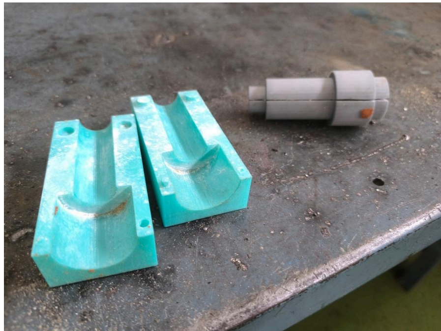
Figura 2. Caja de macho y modelo en impresión 3D. Fuente: Elaboración propia.
