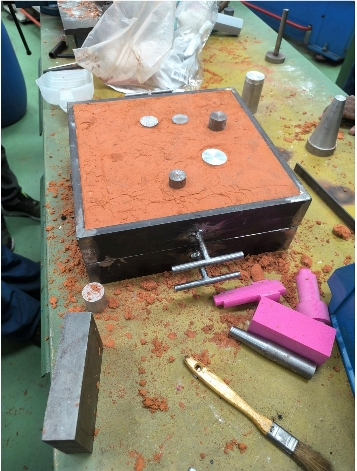
Figura 9. Colocación de los bebederos y mazarotas. Fuente: Elaboración propia.
