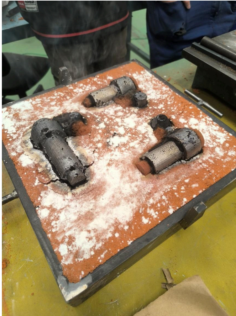
Figura 13. Desmoldeo de las piezas. Fuente: Elaboración propia.
