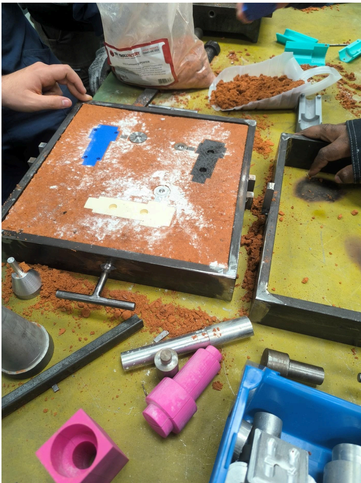
Figura 7. Colocación de los canales de alimentación. Fuente: Elaboración propia.
