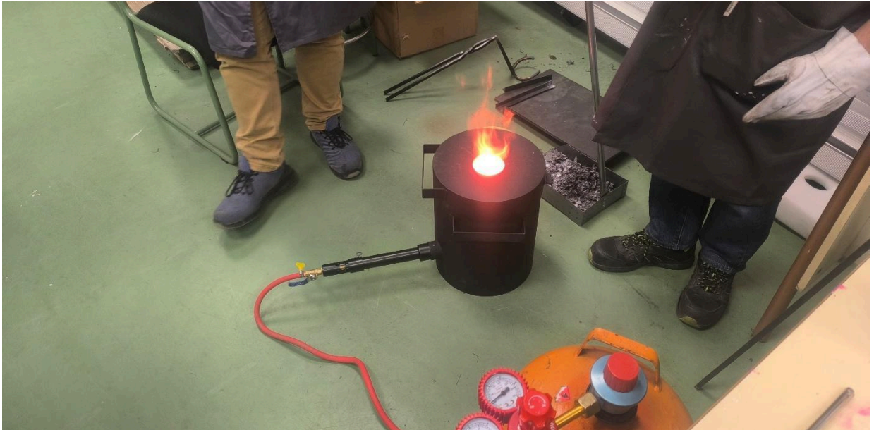
Figura 11. Fundición y retirada de la escoria. Fuente: Elaboración propia.
