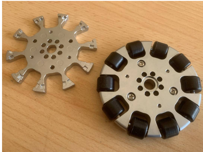
Imagen 6. Rueda omnidireccional comercial. Armadura metálica.
