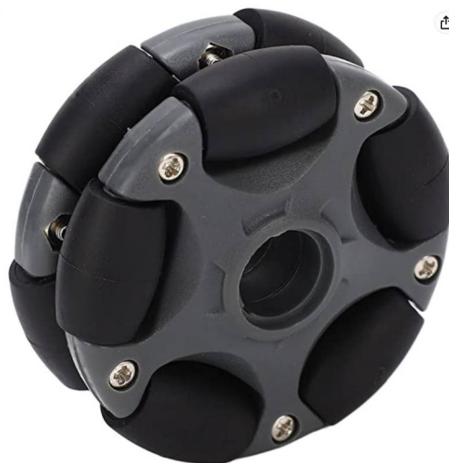
Imagen 1. Rueda omnidireccional. Aparte de su movimiento habitual, puede deslizar en dirección perpendicular a la rotación gracias a sus rodillos.
