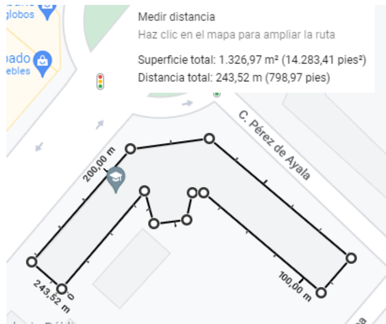
FIGURA 3. MEDICIÓN DEL ÁREA DE LA AZOTEA CON GOOGLE MAPS. IES JIMENA (2022).
