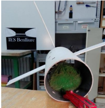
Figura 5. Dispositivo de demostración captación electrostática. Autora: A. Collantes
