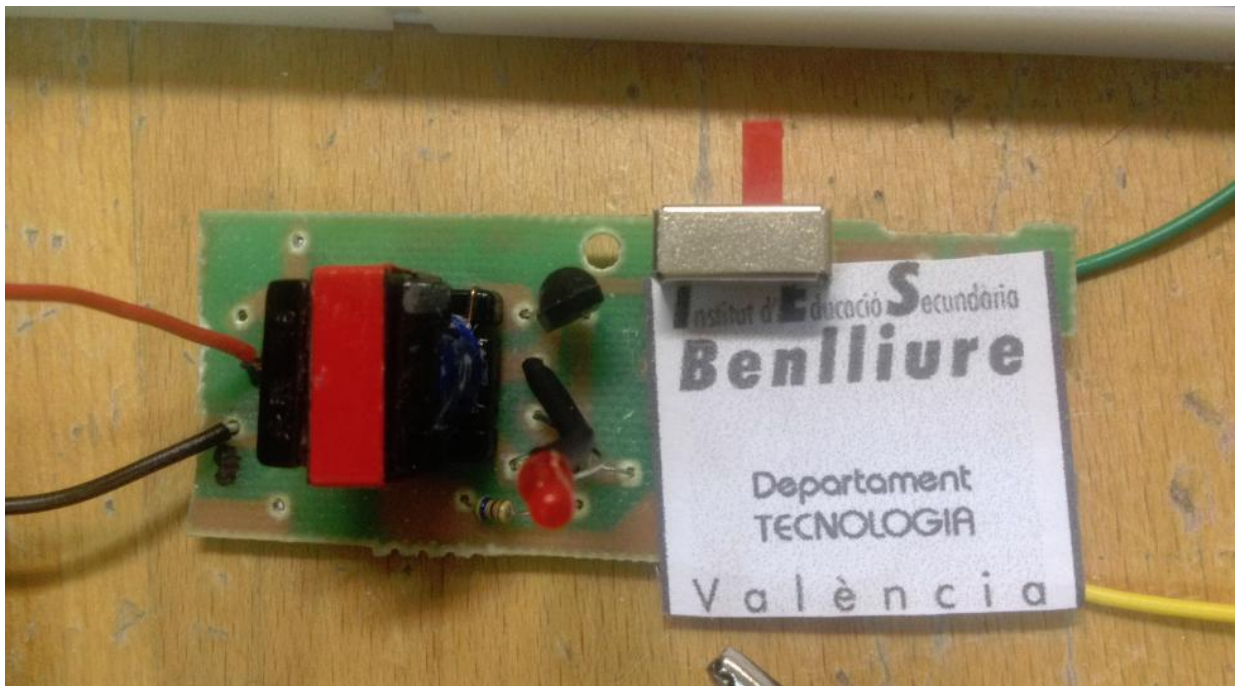
Figura 12. Etapa Elevadora. Autora: P. Domínguez
