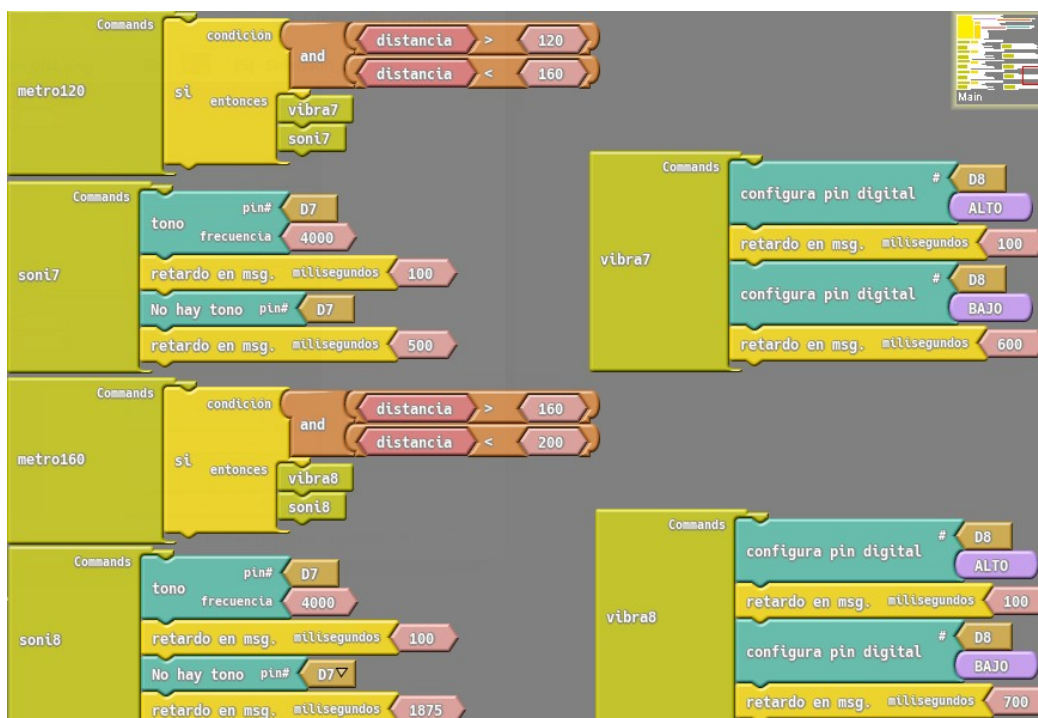
Fig. 19: Captura de pantalla de programa del microcontrolador Arduino Nano 328P, con herramienta de desarrollo Ardublocks. Esta herramienta es capaz de compilar en C el fichero fuente.
