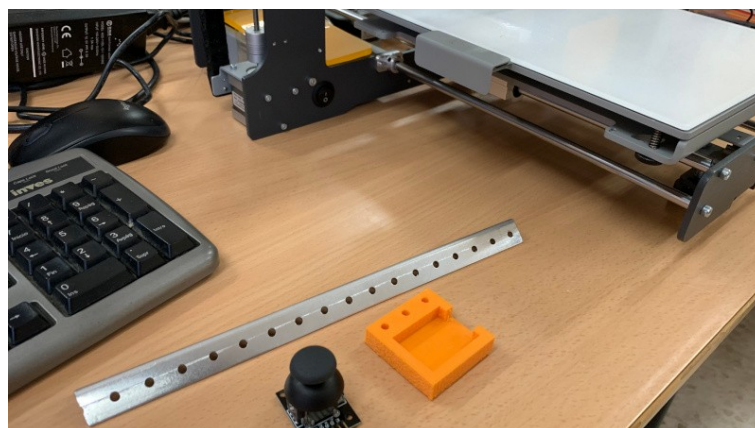
Imagen 8. Porta-joystick hecho con impresora 3D
