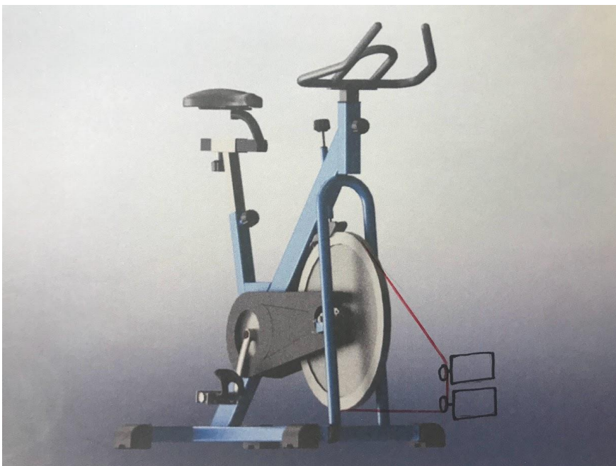
Vista general bicicleta con disposición de alternadores
