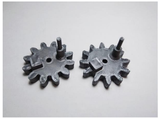
Ilustración 14. Engranajes pequeños impresos. Se muestran: uno tal y como salió impreso (Izq.) y otro tras limar todo lo necesario para que encajara con el engranaje grande (Dcha.)
