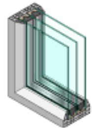
Fig 12. Ventana de triple acristalamiento (29)
