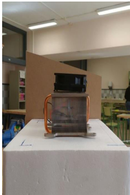
Imagen 4. Segundo frigorífico. Disipadores y ventiladores en la parte superior
